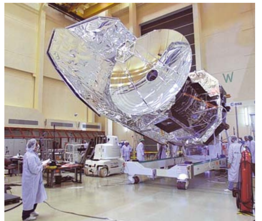
Astrium hat das bisher größte Space-Teleskop gebaut, das eine Beobachtungsposition in 1,5 Millionen Kilometer Entfernung einnehmen wird.
